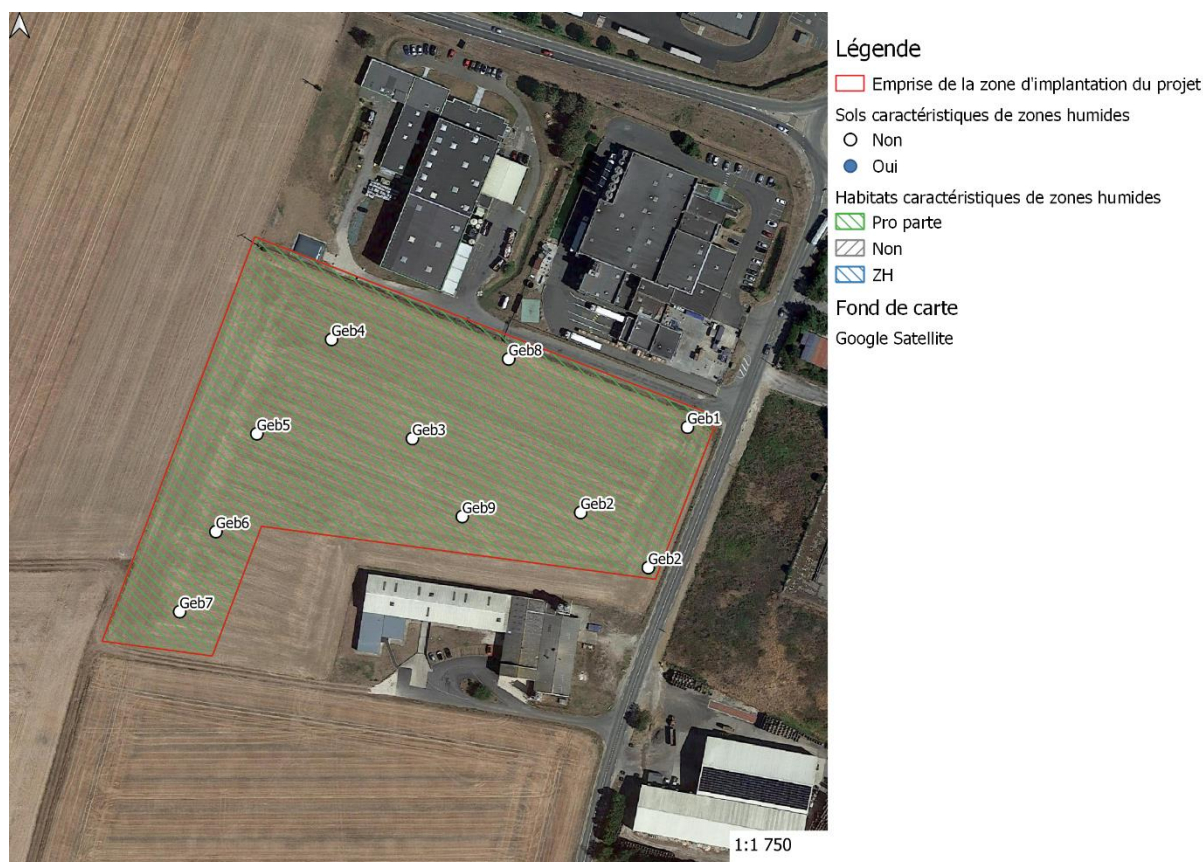
Carte 6 Délimitation des zones humides réglementaires sur la base de l'étude des sols et des habitats
